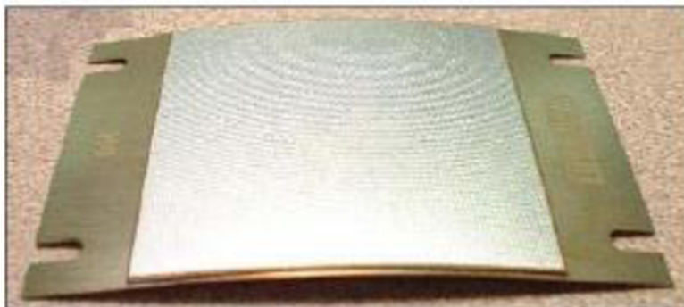
Obrázek 5-7 Lepení keramické vrstvy pomocí technologie THUNDER ® [15]
