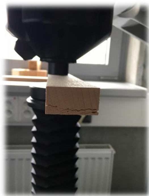
Obr. 34: Porušené místo zkušebního tělesa
