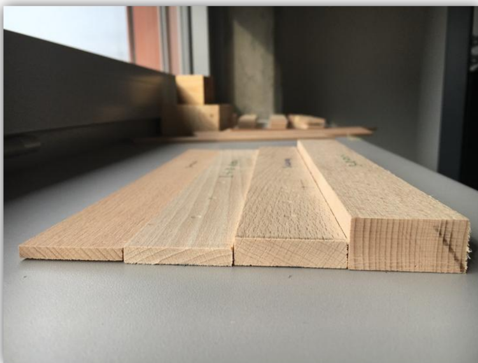
Obr. 25: Zkušební tělesa (buk lesní): zleva 4 mm, 6 mm, 10 mm a 18 mm
