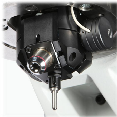
Obr. 30: Měřicí hlava tvrdoměru DuraVision [24]
