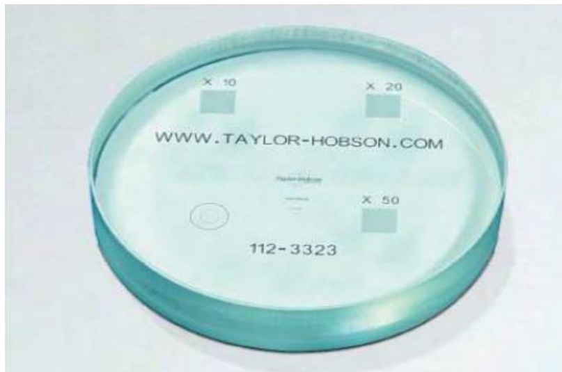
Obr. 25) Etalón s križovou mriežkou od spoločnosti Taylor Hobson [23]
