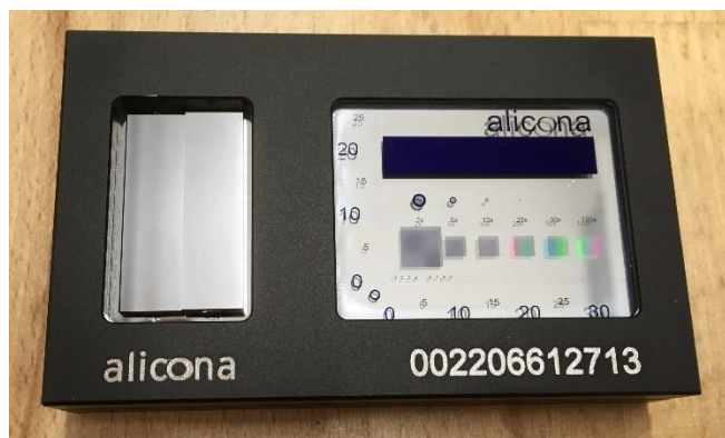
Obr. 24) Na obrázku vľavo etalón výšky stupňa, vpravo samozafarbovací vzor
