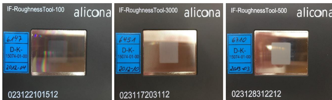
Obr. 22) (a) Vľavo etalón Ra = 100 \text{ nm} , (b) v strede Ra = 500 \text{ nm} a (c) vpravo Ra = 3000 \text{ nm}
