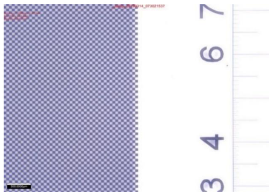
Obr. 26) 2D snímka šachovnicového vzoru zaznamenaná objektívom s 2,5x zväčšením
