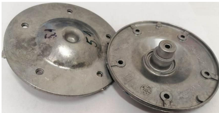
Obr. 19 Odlitek příruby elektromotoru
