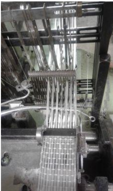
Obr. 15. Tkání vzorku na osnovním stávku Muller Frick typ NF 45 2 x 130mm.
