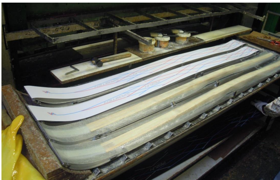
Obr. 10. Kompletace jednotlivých vrstev materiálu lyží a ukázka použití skelné tkaniny jako jedné z vrstev v lyži.
