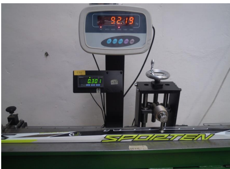
Obr. 9. Zařízení pro zjištění tvrdosti, délky a výšky voskovací komory lyží – detail.
