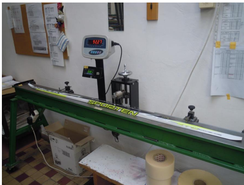
Obr. 8. Zařízení pro zjištění tvrdosti, délky a výšky voskovací komory lyží - celkový pohled.
