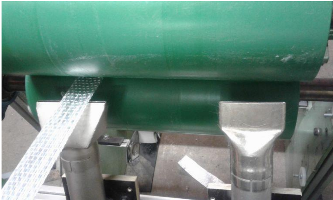
Obr. 16. Natavení tavné nitě ohříváčem Leister LHS 41S před kalandrováním.
