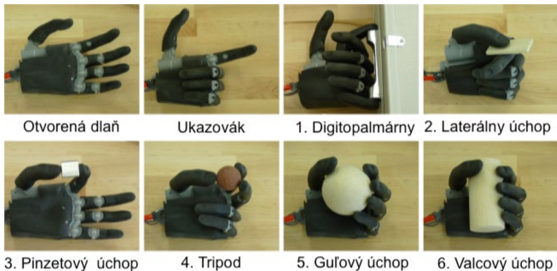
Obrázok 12. Možnosti úchopov bionickej protézy.
