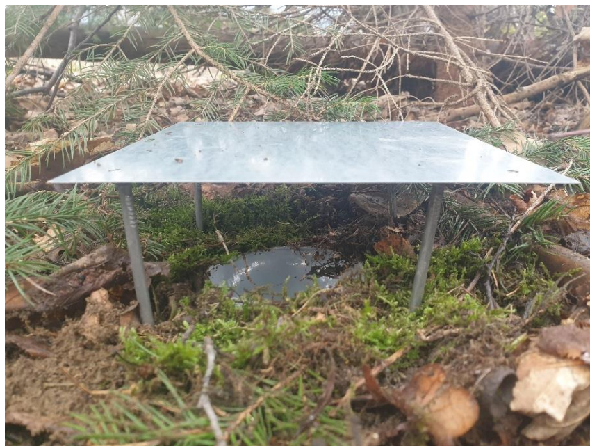
Obrázek 8; Kompletní instalovaná zemní past.
