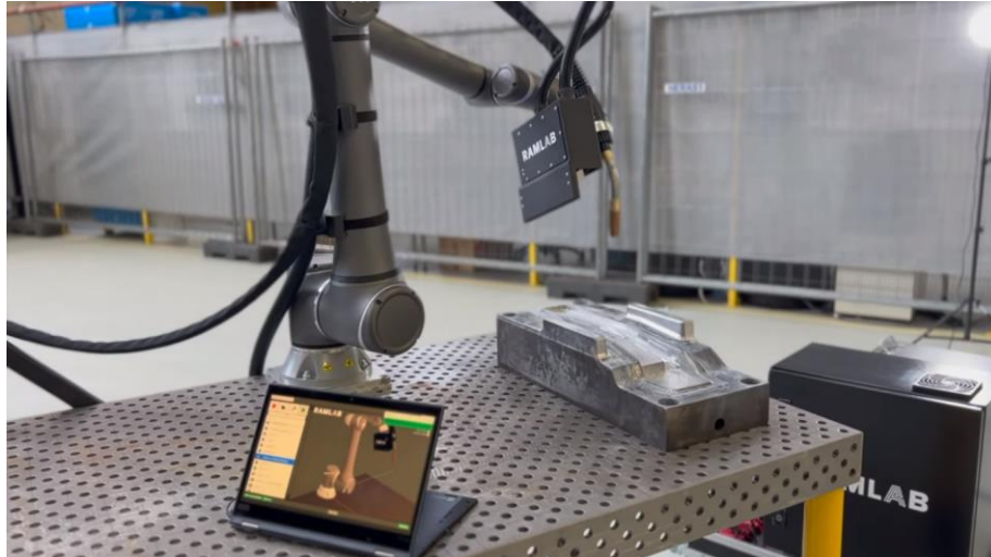
Obrázek 19 - Proces navařování firmy RAMLAB [21]
