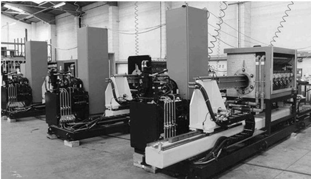
Obrázek 22 - Indukční pece pro ohřev dlouhých polotovarů [25]
