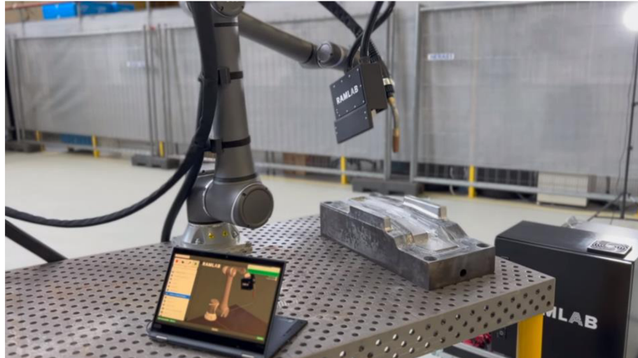
Obrázek 19 - Proces navařování firmy RAMLAB [21]
