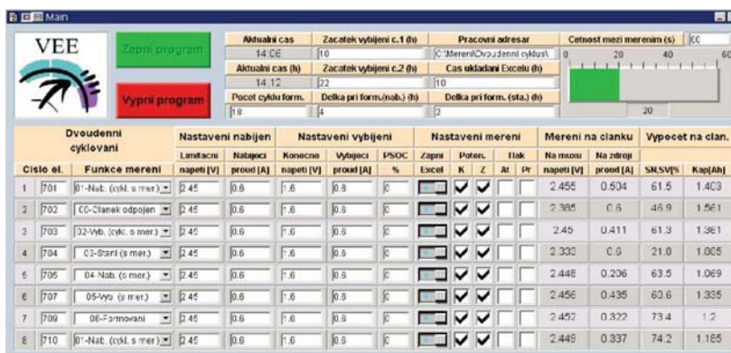
Obr. 22: Ovládací panel programu „12h/24h cyklování“ na automatizovaném měřicím pracovišti
