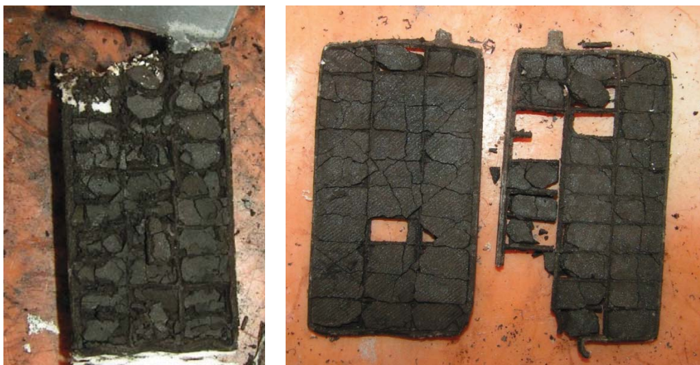
Obr. 14: Příklad rozpadu soudržnosti kladné aktivní hmoty, koroze kolektoru kladné elektrody
