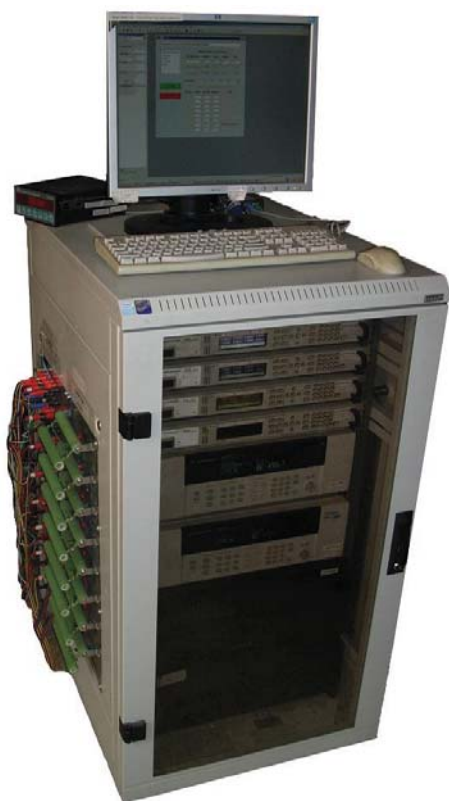
Obr. 20: Skříň a uspořádání přístrojů automatizovaného měřicího pracoviště
