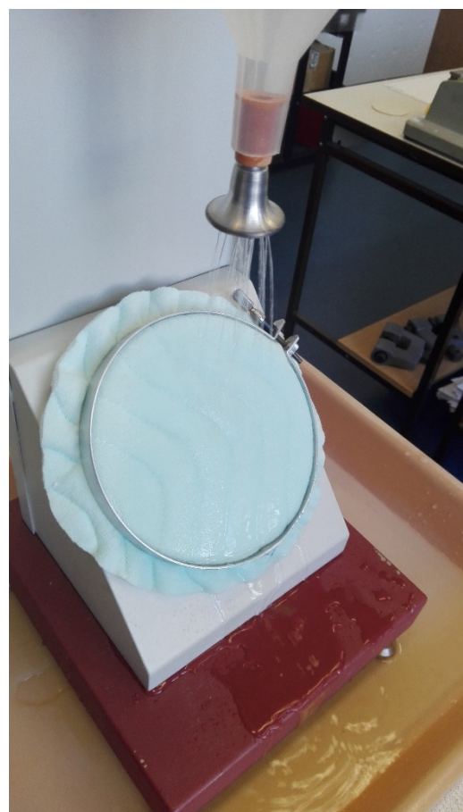
Obrázek 27 Sprey test - povrchové smáčení vzorku Clinitek
