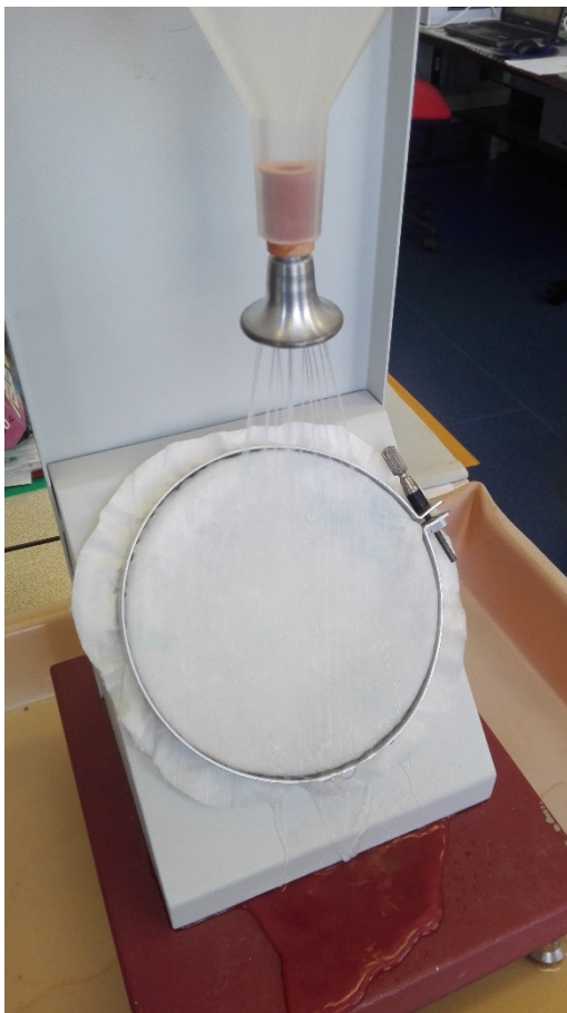
Obrázek 26 Sprey test - povrchové smáčení vzorku Seni
