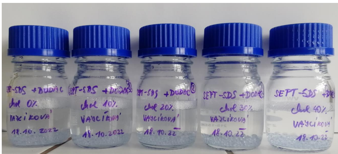
Obr. 23: Vzorky vezikulárných systémov s rôznym obsahom cholesterolu krátko po aplikácii ultrazvukovej dispergácie.
