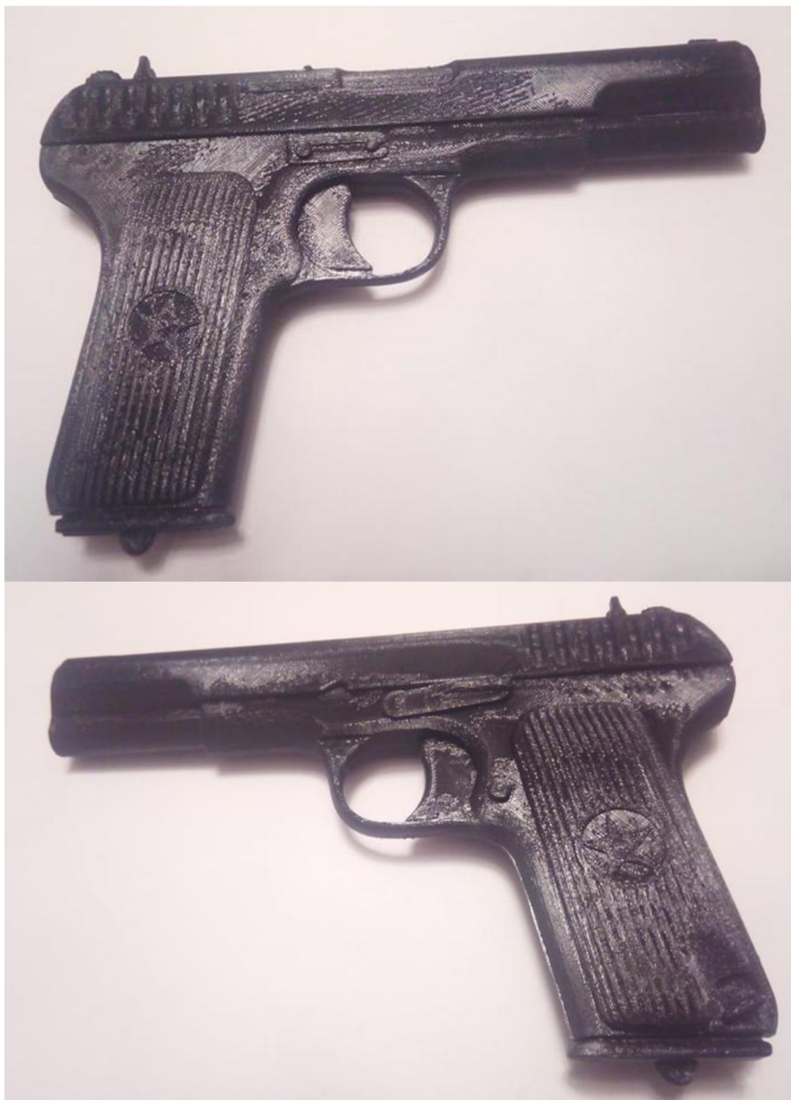
Příloha č.2: Fotografie vytištěného modelu Tokarev
