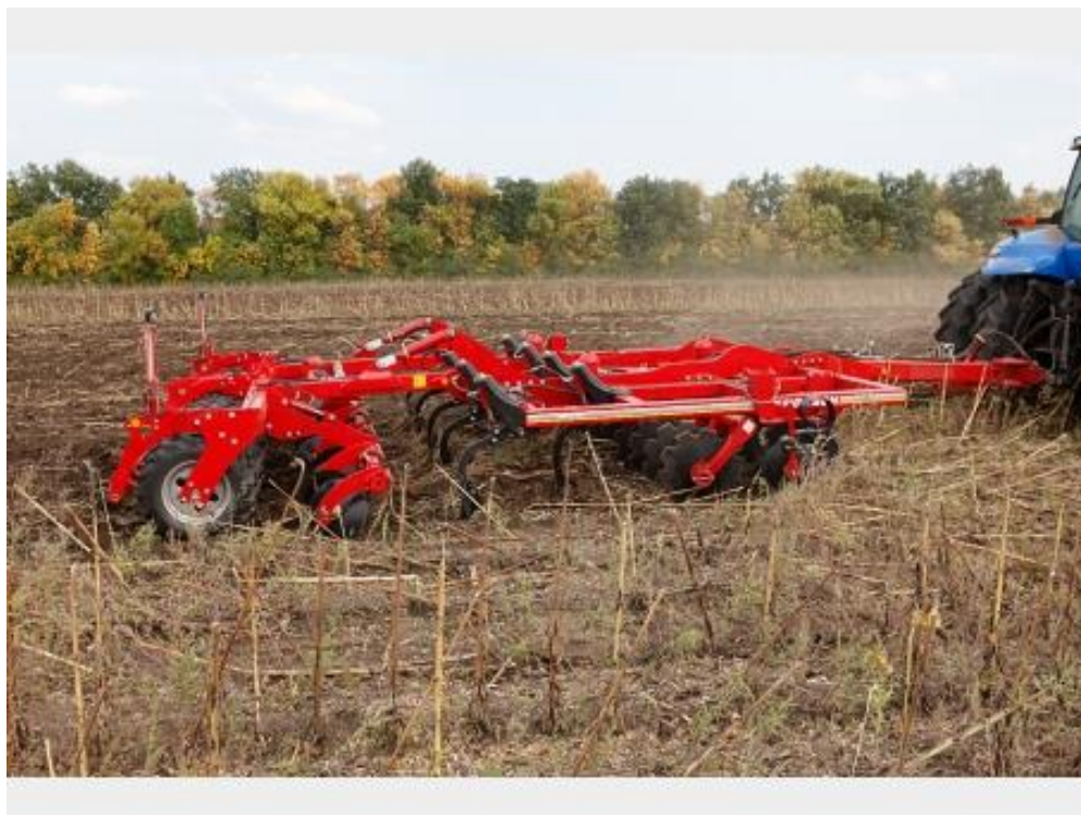
Obr.10: Horsch Tiger MT pro střední a hluboké zpracování půdy [31]
