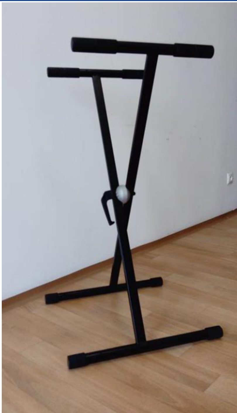
Obr. 6.1 Stojan pro klávesy s vyrobenou fixační rukojetí.
