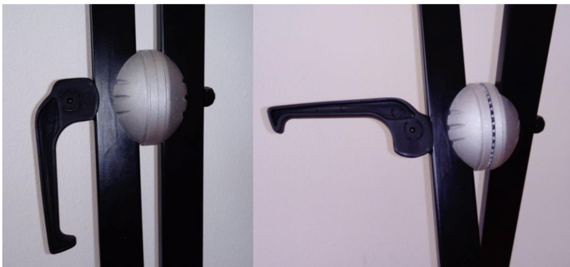
Obr. 4.14 Fixační rukojeť: a) v zafixované poloze, b) v uvolněné poloze.
