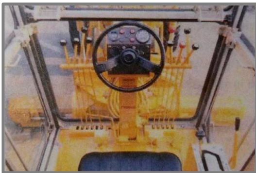
Obr. 2-27 Mechanické ovládání graderu [8]
