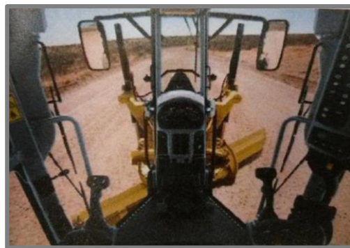
Obr. 2-28 El. – hydraul. ovládání graderu [8]
