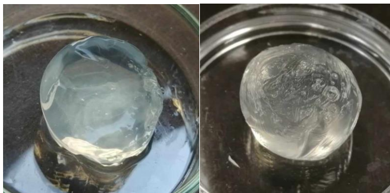
Obrázek 19: Alginát o koncentraci 1 hm. % s přídavkem 0,75 ml chloridu vápenatého o koncentraci 0,1 \text{ mol/dm}^3 (vlevo) a alginát s přídavkem 1,25 ml chloridu vápenatého o koncentraci 0,1 \text{ mol/dm}^3 (vpravo).
