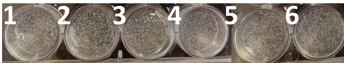
Obrázek 37: Sítování alginátu uhličitánem vápenatým v kombinaci s GDL – vliv přidavku dihydrogenfosforečnanu draselného.
