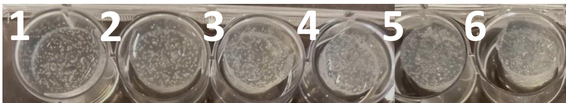
Obrázek 39: Síťování alginátu uhličitanem vápenatým v kombinaci s GDL – vliv přidavku kyseliny citronové.
