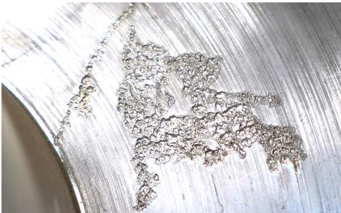
Obrázek 3: Vliv působení kavitační eroze na oběžné kolo odstředivého čerpadla [5]
