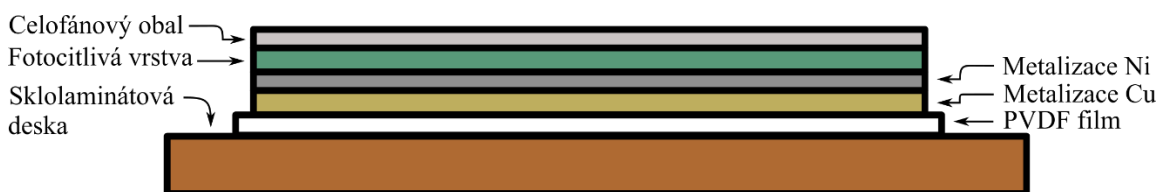
Obrázek 11: Struktura PVDF senzoru po laminování
