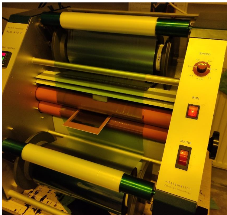
Obrázek 12: Laminovací proces při výrobě PVDF senzoru
