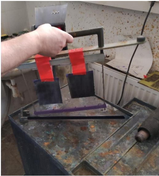
Obrázek 16: Vkládání PVDF senzoru do vyvolávací lázně
