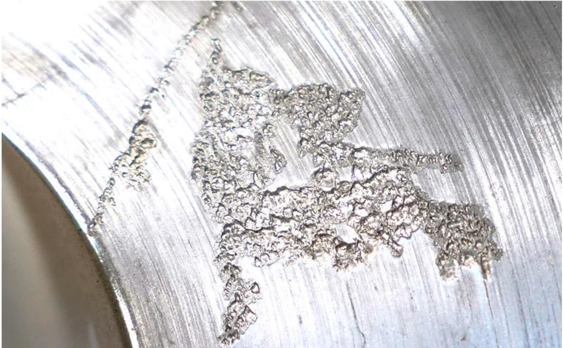
Obrázek 3: Vliv působení kavitační eroze na oběžné kolo odstředivého čerpadla [5]
