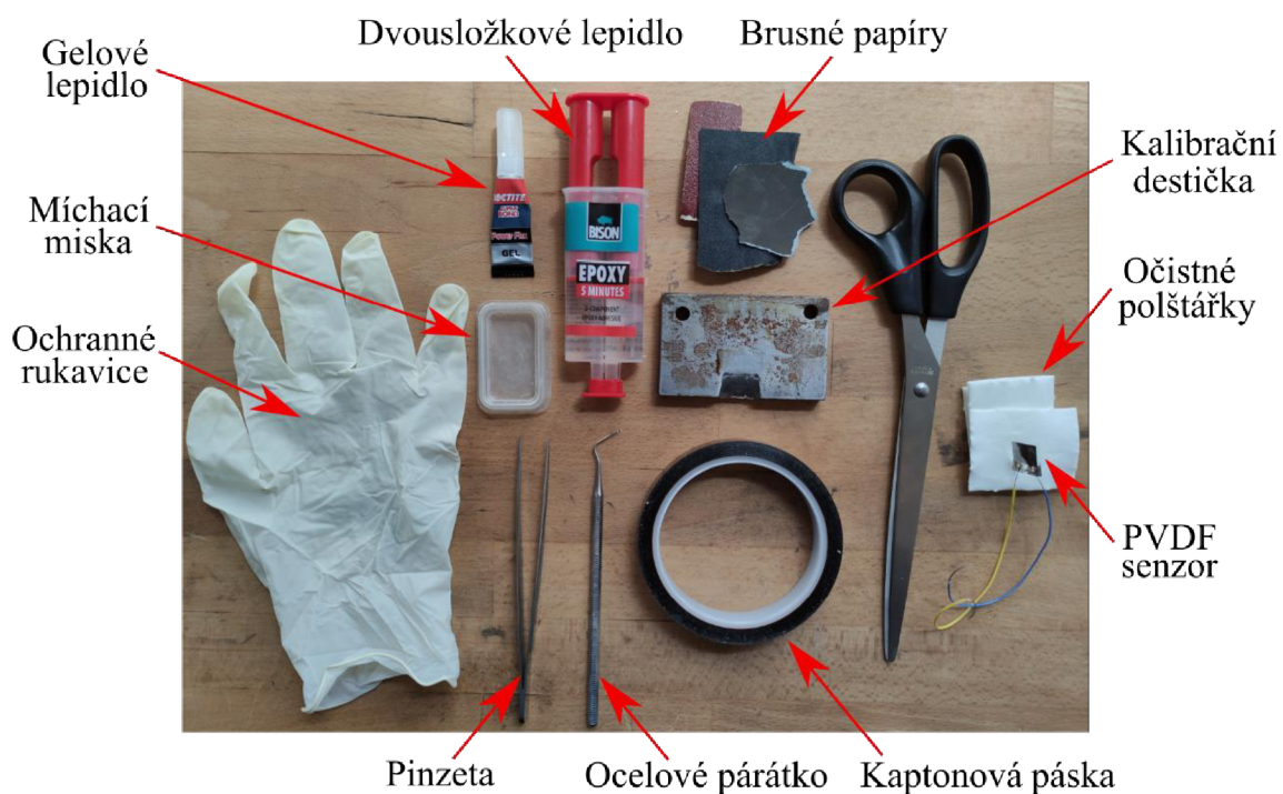
Obrázek 25: Sada nástrojů pro připevnění PVDF senzoru s kalibrační destičkou
