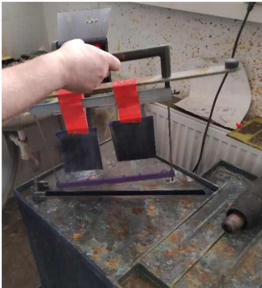
Obrázek 16: Vkládání PVDF senzoru do vyvolávací lázně
