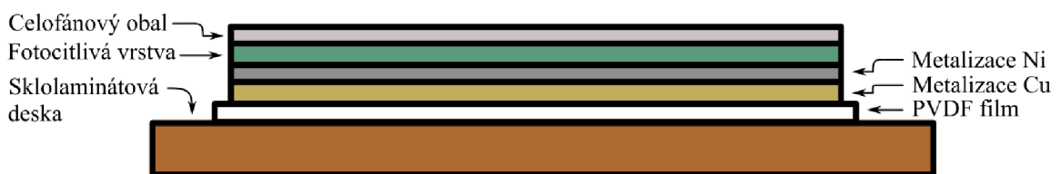
Obrázek 11: Struktura PVDF senzoru po laminování
