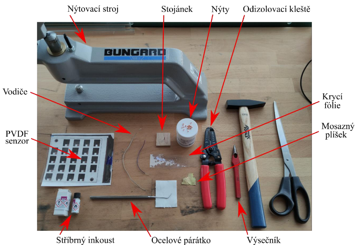
Obrázek 22: Sada nástrojů pro tvorbu elektrod
