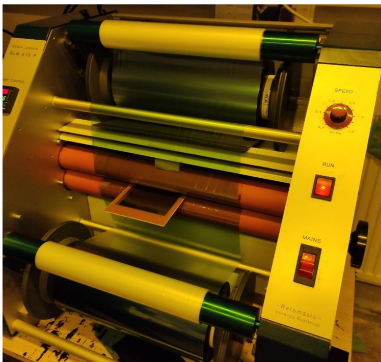
Obrázek 12: Laminovací proces při výrobě PVDF senzoru
