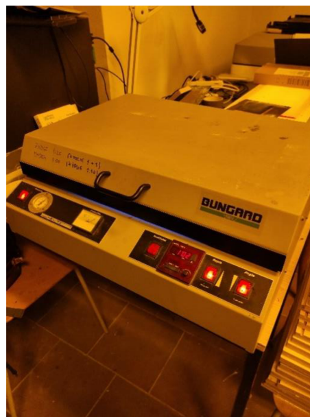
Obrázek 14: Proces expozice fotorezistu
