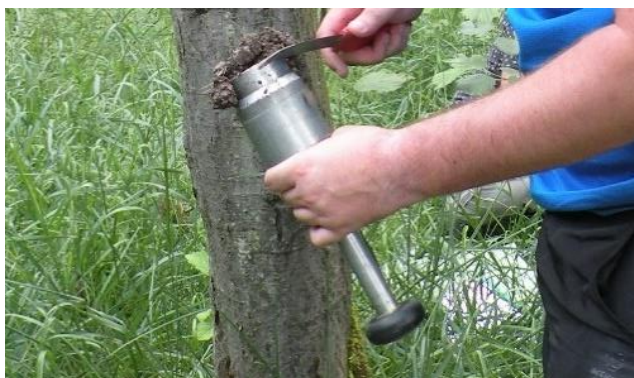
Obr. 11: Odřezávání přebytečné zeminy od neporušeného vzorku
