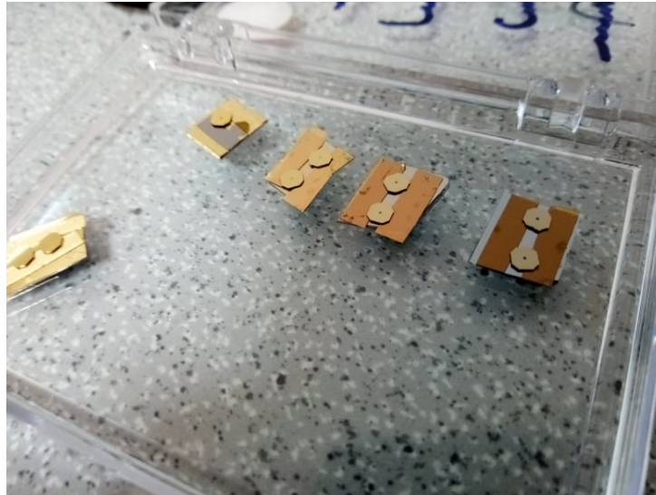
Obrázek 2.3: Fotografie SiN membrán pokrytých homogenní vrstvou zlata a nalepených na křemíkovou destičku
