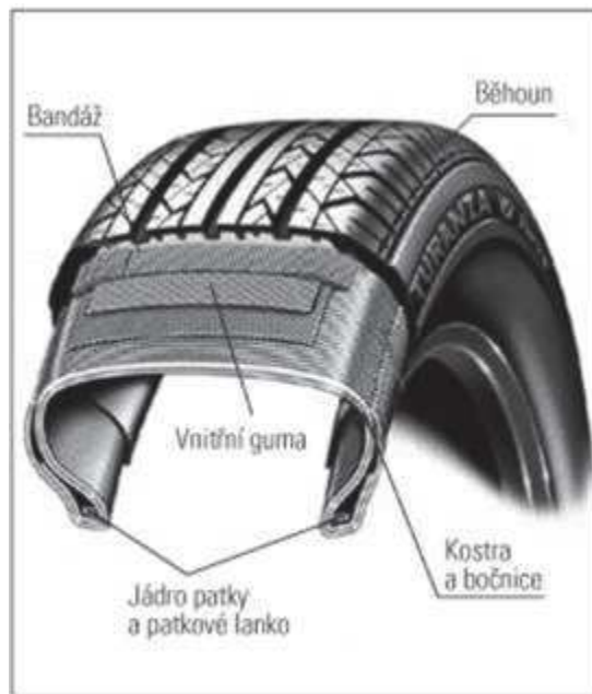
Obrázek 3 - Základní struktura pneumatiky
