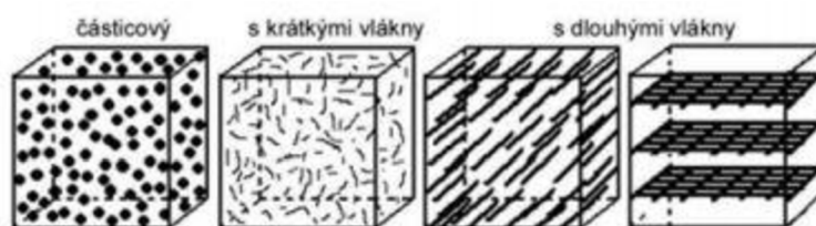
Obr. 6 Rozdělení kompozitů podle geometrického tvaru plniva [10]
