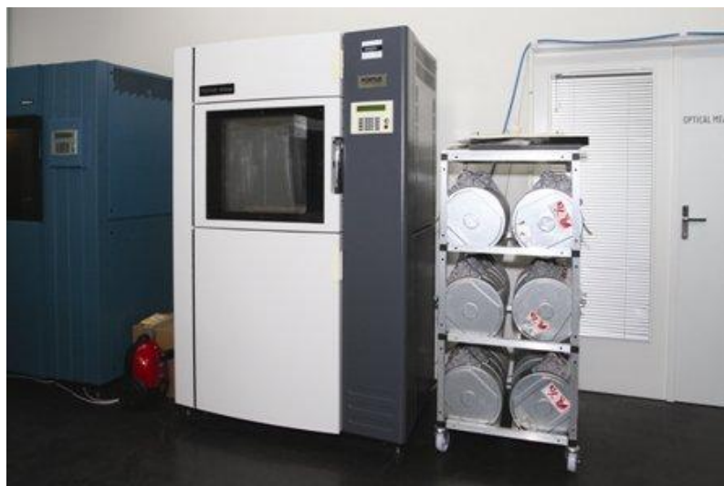
Obrázek č.3: 3D výrobní zařízení Fortus 400mc firmy Stratasys
