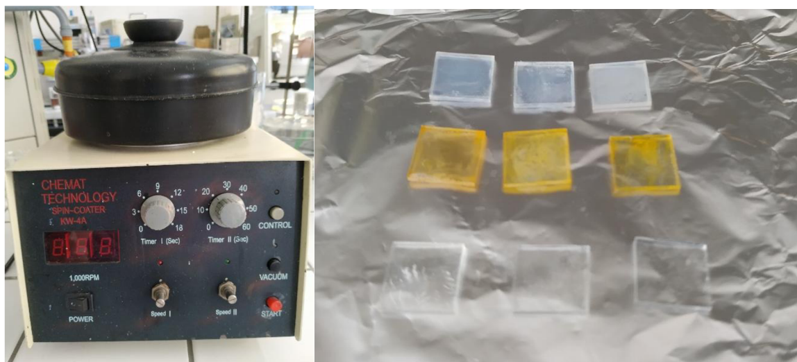
Obr. 37 Vľavo použitý laboratórny spincoater, vpravo merané sady vzoriek (zhora dole PbBr_2 , MAPbBr_3 , MABr )
