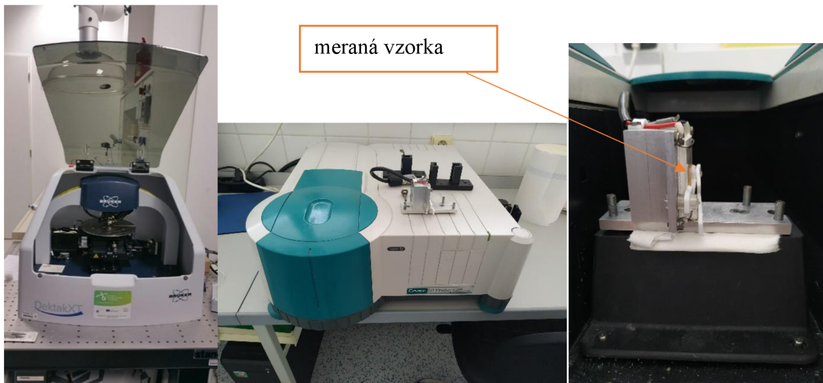
Obr. 38 Zľava doprava profilometer DektakXT, spektrofotometer Varian Cary Probe 50 a nástavec na meranie pevných vzoriek s vyznačeným miestom uloženia vzorky.
