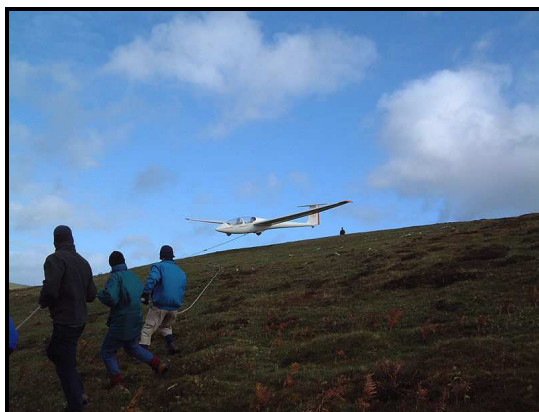
Obr. 63 Vzlet za pomoci pružného lana [36]
