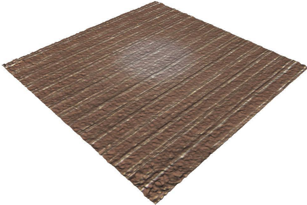
Obr. 62 – Snímek ze zařízení Alicona – vzorek materiálu PETG po dvanácti měsících v bioaktivním prostředí.
