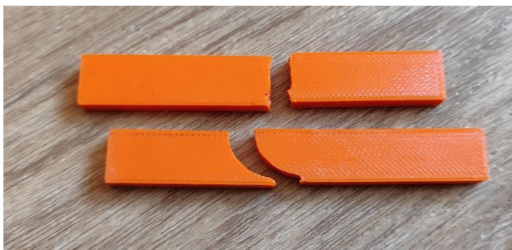
Obr. 38 – Vzorek přeražený kolmo (nahore) a vzorek přeražený s nerovnou oblastí porušení (dole).
