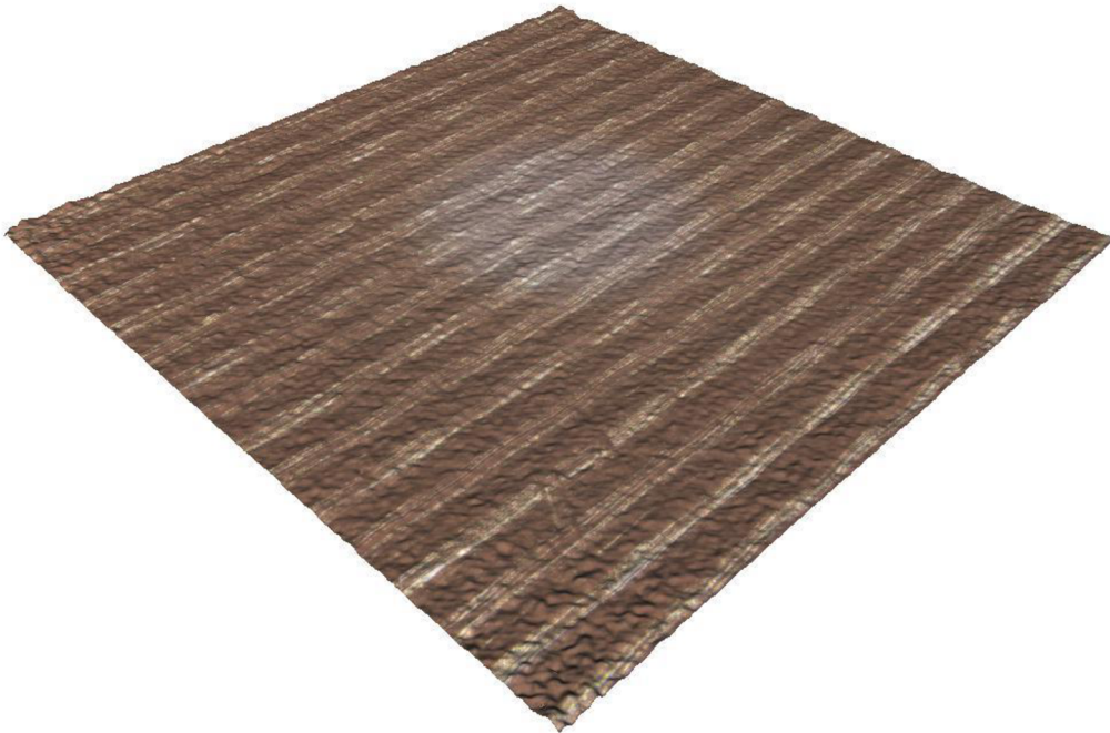
Obr. 61 – Snímek ze zařízení Alicona – vzorek materiálu PETG po osmi měsících v bioaktivním prostředí.
