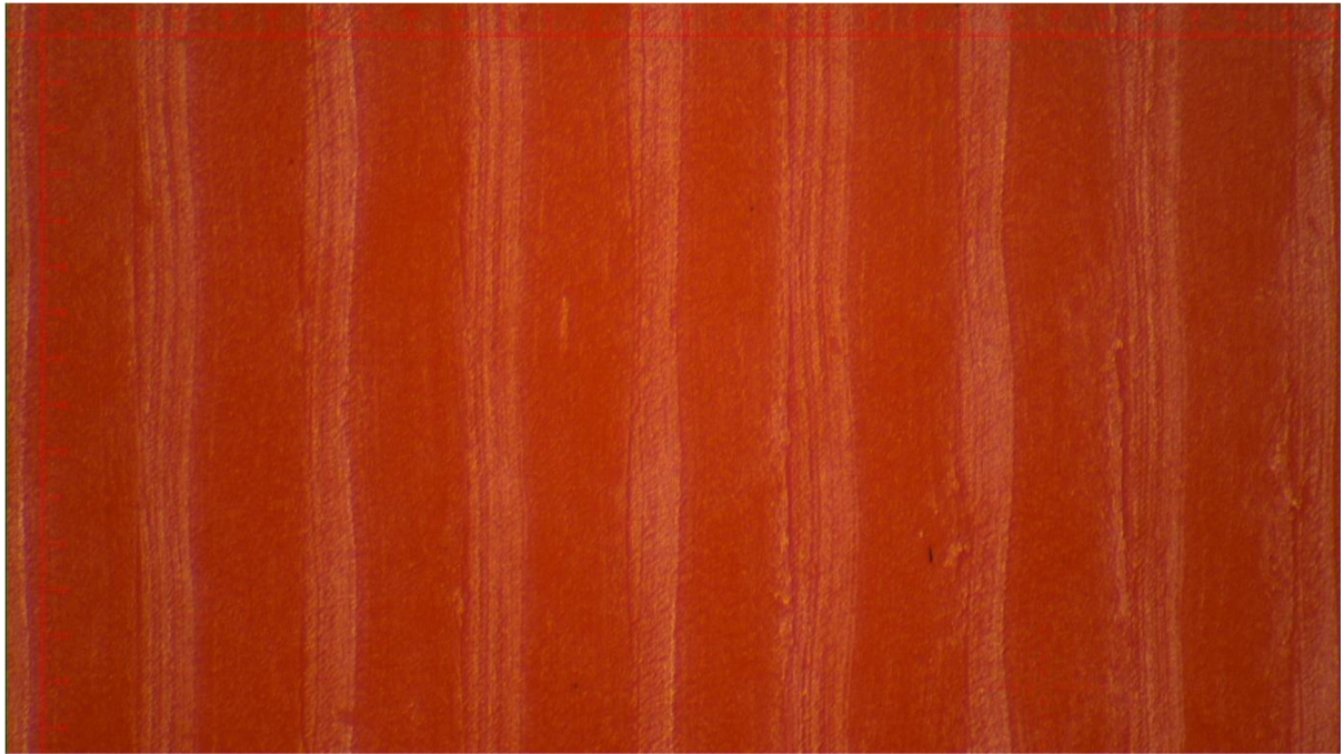
Obr. 56 – Snímek z mikroskopu – vzorek materiálu PETG po čtyřech měsících v bioaktivním prostředí.
