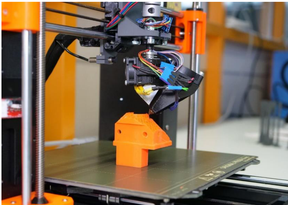
Obr. 4 – Kinematika usnadňující tisk převisů. [12]
