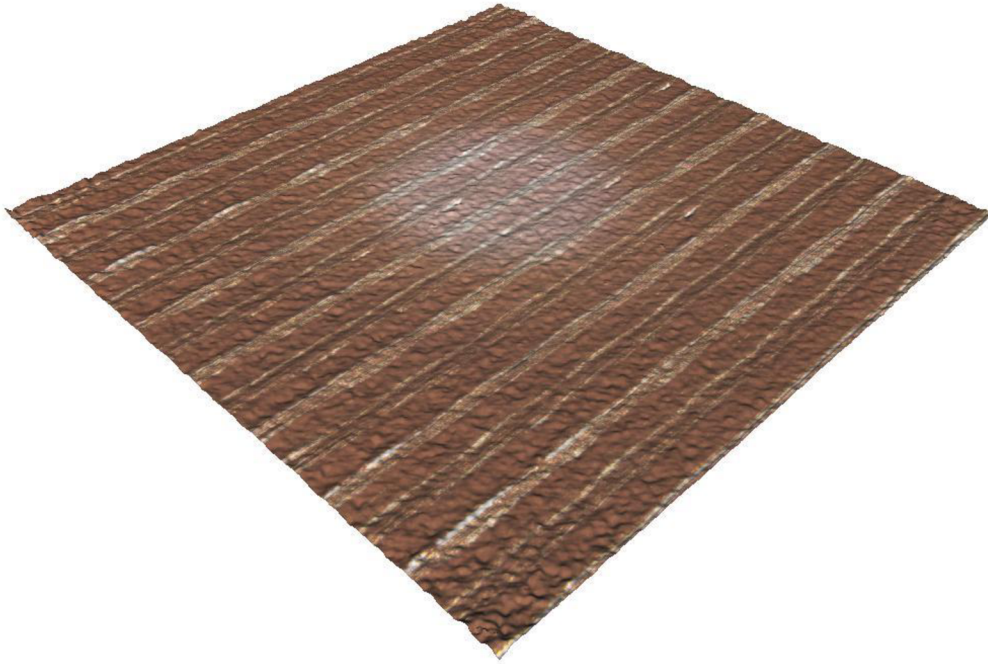
Obr. 60 – Snímek ze zařízení Alicona – vzorek materiálu PETG po čtyřech měsících v bioaktivním prostředí.
