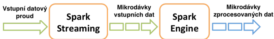
Obrázek 13 Proces zpracování událostí u Spark Streaming. Podle: [67]
