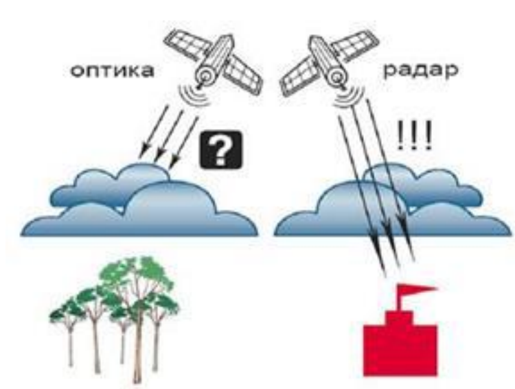
Obr. 3: Vlastnosti optického a radarového snímání
