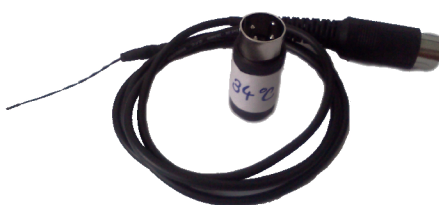
Obr. 6.4: Provedení senzoru a kalibrační koncovky
