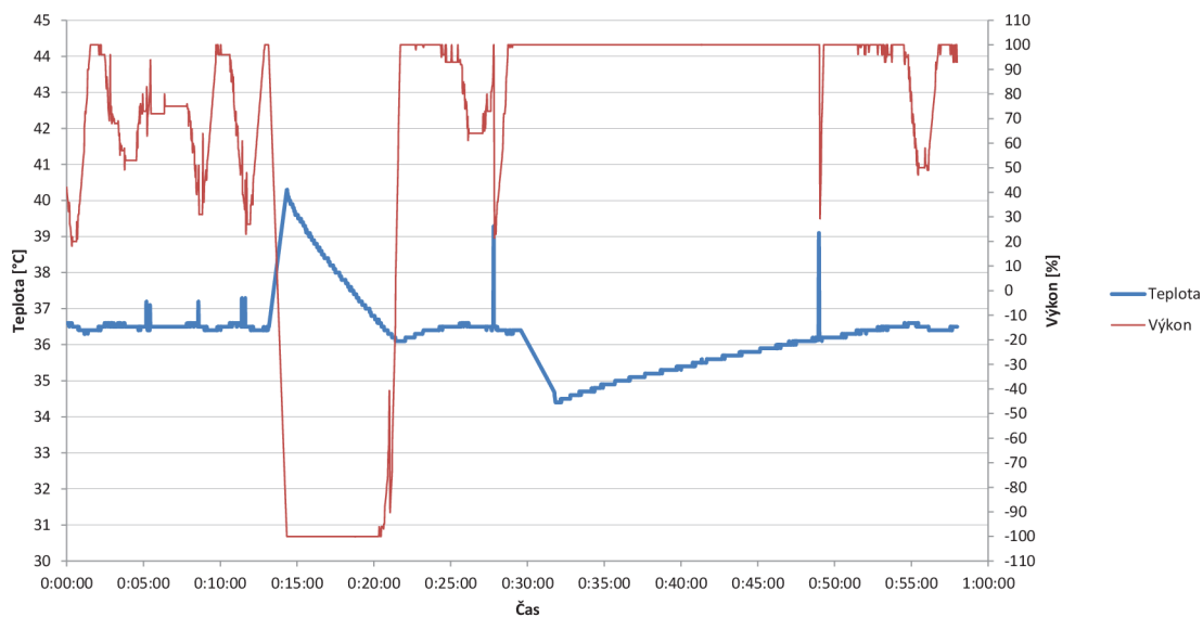
Obr. 7.4: Reakce PSD regulátoru na skokové změny teploty
