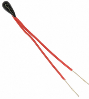
Obr. 1.4: Ukázka perličkového termistoru
