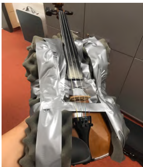
(a) Housle se zatlumeným rezonančním tělem
