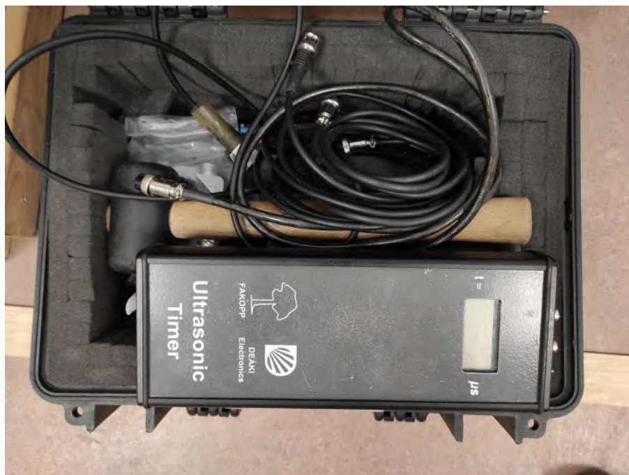
Obr. 1.6: Přístroj na měření rychlosti zvuku pomocí ultrazvuku
