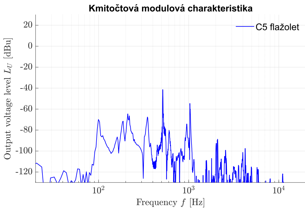
Obr. A.40: Kmitočtová charakteristika, materiál jasan, tóny a3 a c5
