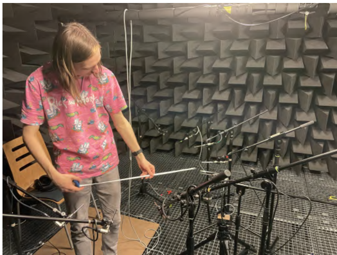
Obr. 4.4: Příprava půlkruhu mikrofونů pro měření směrovosti.
