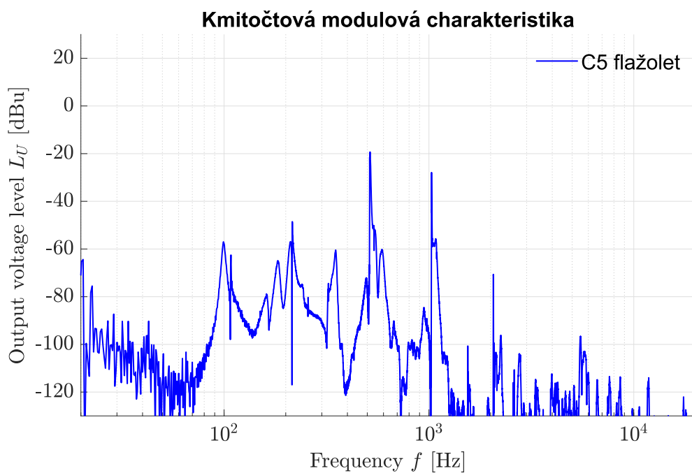
Obr. A.34: Kmitočtová charakteristika, materiál cocobolo, tóny a3 a c5
