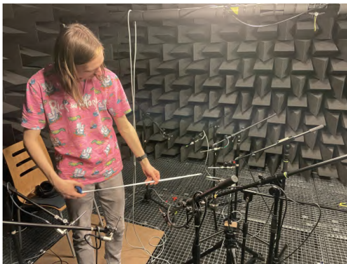
Obr. 4.4: Příprava půlkruhu mikrofonů pro měření směrovosti.
