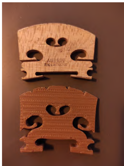
Obr. 2.1: Srovnání dřevěné a plastové kobylky
