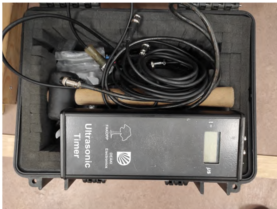
Obr. 1.6: Přístroj na měření rychlosti zvuku pomocí ultrazvuku
