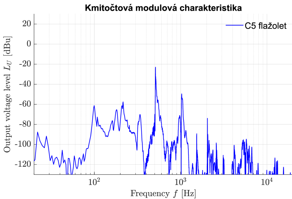
Obr. A.37: Kmitočtová charakteristika, materiál eben, tóny a3 a c5
