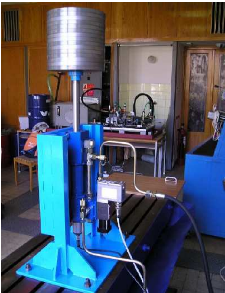
Obr. 10 - Zařízení pro měření dynamických vlastností lineárního servopohonu [13]
