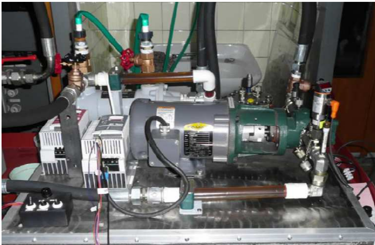
Obr. 11 - Zařízení pro měření kavitace zubového čerpadla [13]
