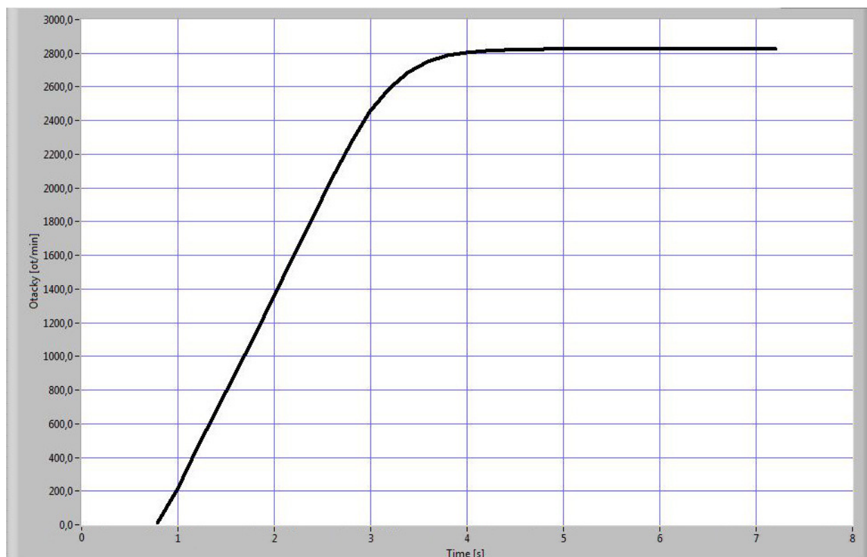
Obr. 3.4.1 Rozběh asynchronního motoru EMP Slavkov u Brna
