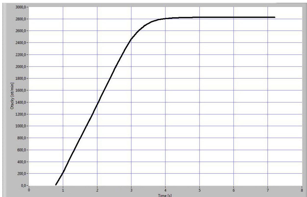
Obr. 3.4.1 Rozběh asynchronního motoru EMP Slavkov u Brna
