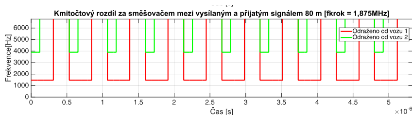
Obrázek 3.9 - Obrázek 3.8 (dole) v detailu pro viditelnost Dopplerovy frekvence
