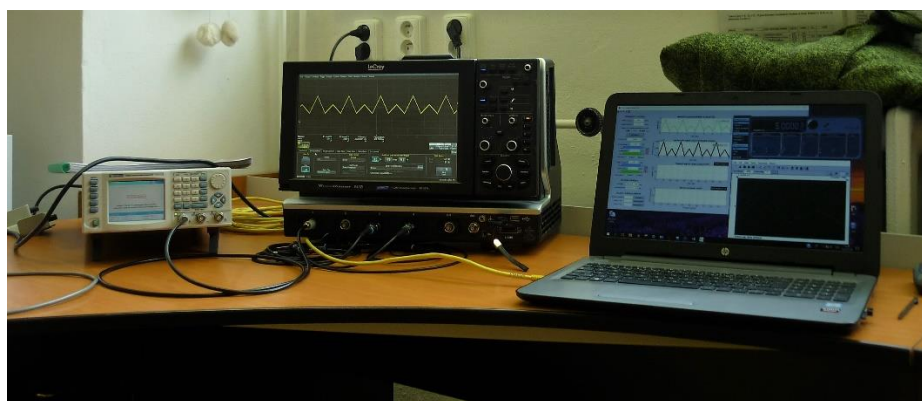
Obrázek 4.17 - Pracoviště použité pro sestavení modulačního signálu
