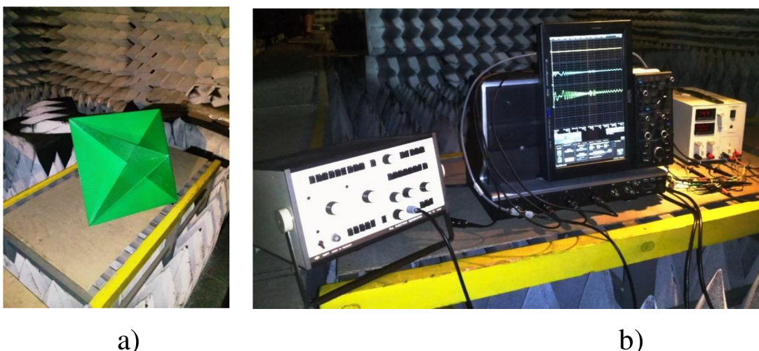
Obrázek 4.20 - Koutový odražeč a) Měřicí pracoviště (zleva: funkční generátor MS, Osciloskop LeCroy WaveRunner 640Zi, Stabilizovaný zdroj Diametral P130R51D b)
