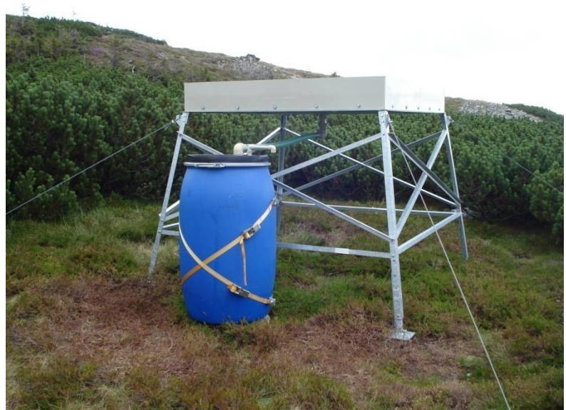
Foto 14 Zařízení na jímání srážkové vody
