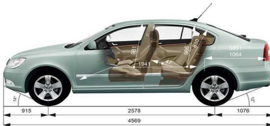
Obr. 4.7 Boční pohled s rozměry na Škodu Octavia [19]
