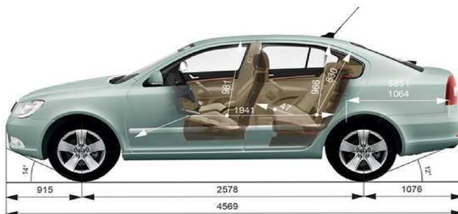
Obr. 4.7 Boční pohled s rozměry na Škodu Octavia [19]
