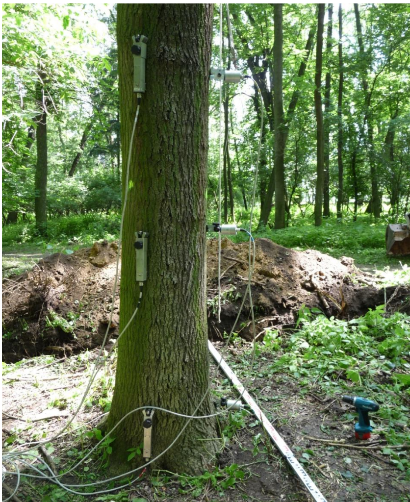
Příloha 15. Umístění inklinometru a elastometru, strom č. 2
