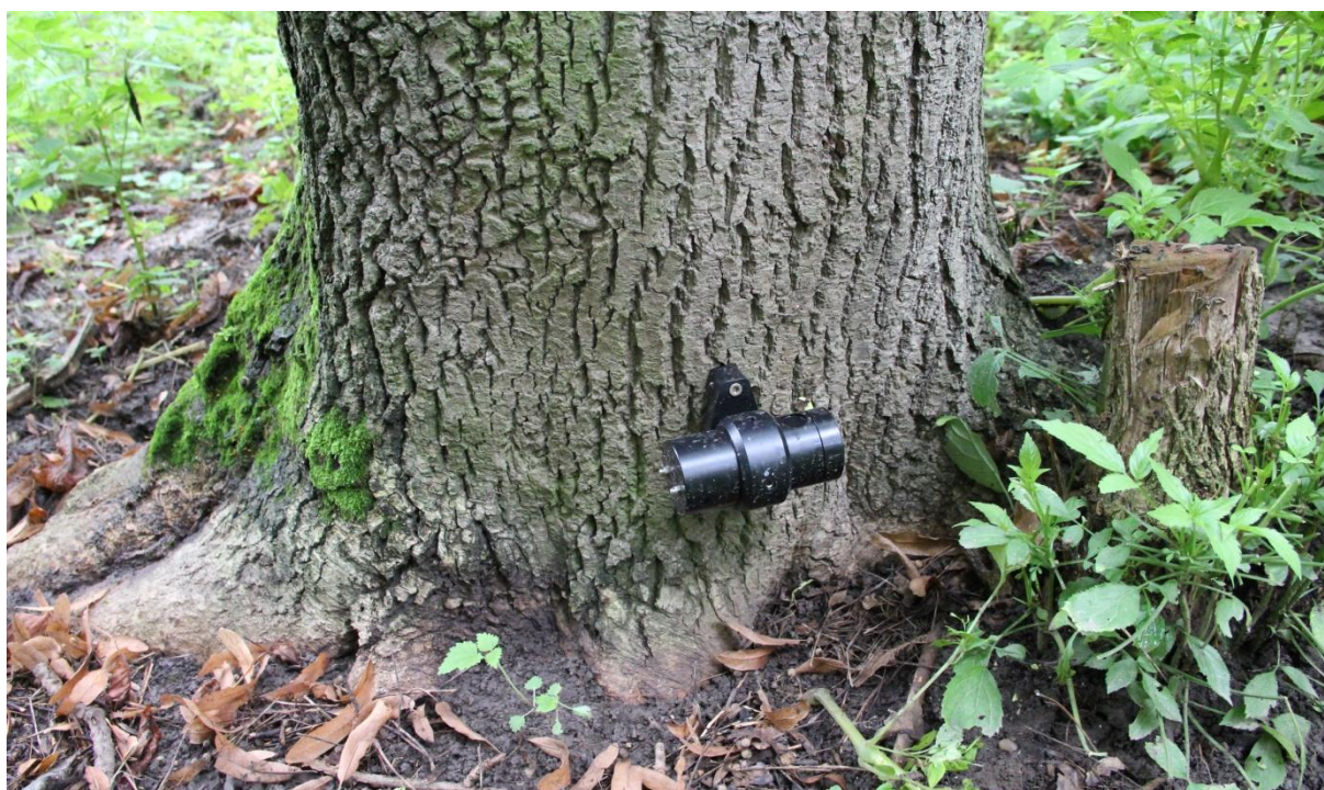
Příloha 12. Umístění akcelerometru na bázi kmene, strom č. 1
