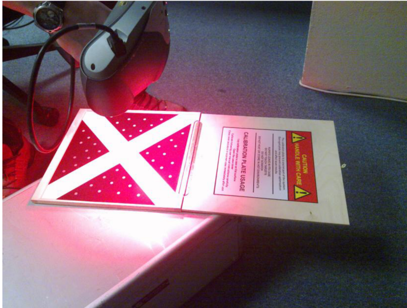
Obr. 2.4: Kalibrácia 3D HandyScan.
