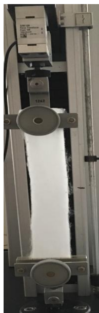
Obr. 32: Upevnění vlákenného vzorku v přístroji měřící pevnost
