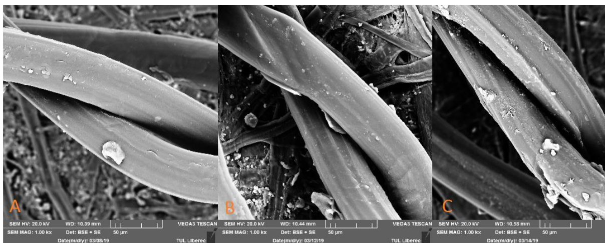
Obr. 40: Snímky uzlíků za sucha ze SEM – vzorek č.2
