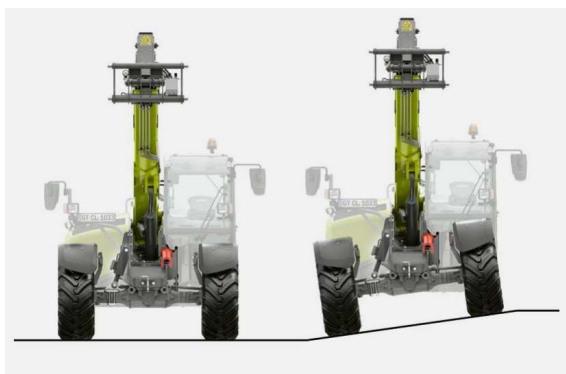
Obrázek 9: Znázornění vyrovnávání náklonu v oficiální brožuře Claas Scorpion
