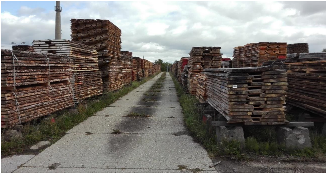
Obrázek č. 8: Uskladnění řeziva v balících s prokladem na betonových patkách
