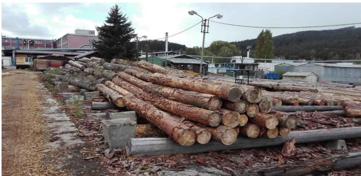
Obrázek č. 7: Uložení kulatiny v dřevoskladu do hrání podle čepové tloušťky
