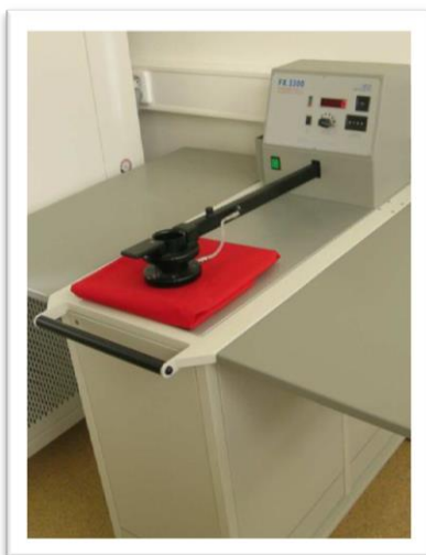
Obr. č. 9: Prístroj TEXTEST FX 3300 na TUL
