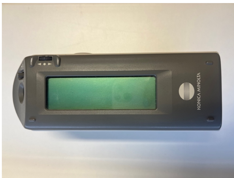
Obr. 18: Spektrofotometr Konica Minolta CM-2500d (archiv autorky práce).
