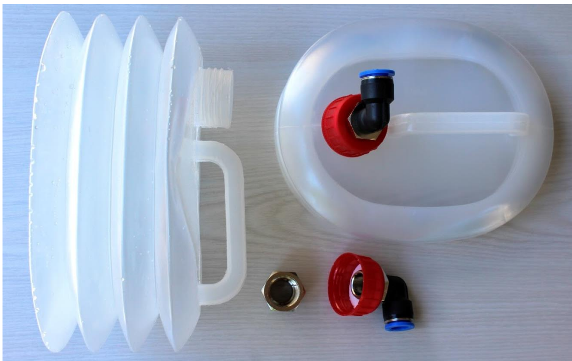
Obr. 10 Nafukovací vaky (zdroj: vlastní)
