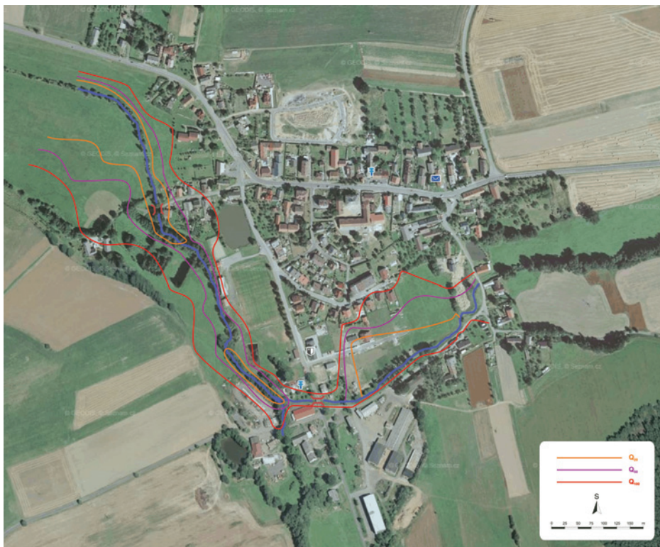
Obr. 2. Vytyčení záplavového území Fig. 2. Scheme of floodplain
