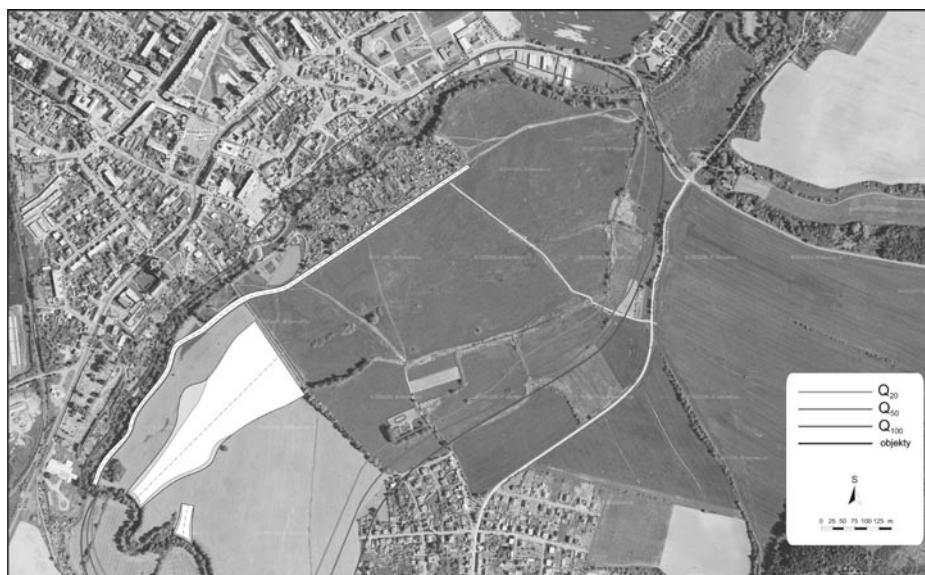
Obr. 6. Záplavové území po realizaci protipovodňových opatření
